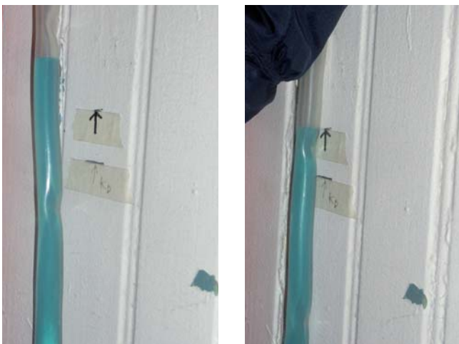
Et slangevater er en blank plastslange med egne endestykker som fylles med vann og som brukes til å finne samme horisontalnivå for to punkter.
