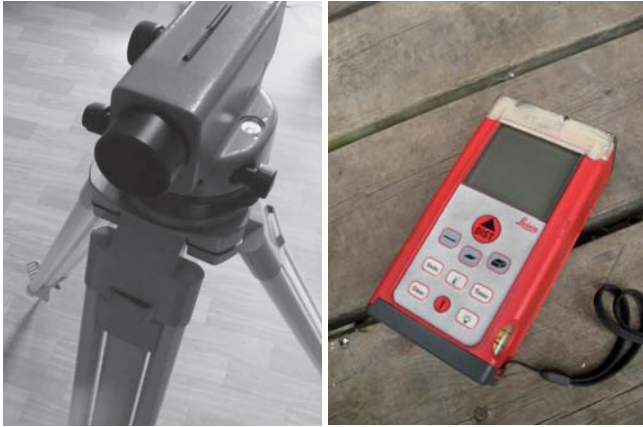
Nivelleringskikkert med stativ (til venstre) og håndholdt lasermåler.
